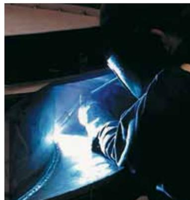
Gerade beim MIG- und WIG-Schweißen von Aluminium und Aluminiumlegierungen bestehen oft erhöhte Anforderungen an die Nahtqualität bezüglich Poren und Oberflächengüte. Aus diesem Grund sind bei den ARCAL™-Schweißschutzgasen die störenden Nebenbestandteile deutlich enger definiert als bei Standardgasen.
